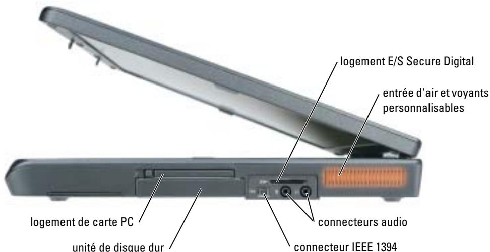
**LOGEMENT E/S SECURE DIGITAL** — Le logement E/S Secure Digital prend en charge une carte de mémoire Secure Digital ou un autre périphérique SDE/S. Les cartes mémoire Secure Digital servent à enregistrer ou sauvegarder des données.
