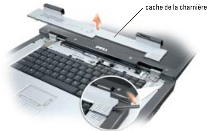
Pour remettre en place le cache de la charnière, insérez tout d'abord son côté gauche, puis appuyez de gauche à droite jusqu'à ce que le cache s'enclenche.
